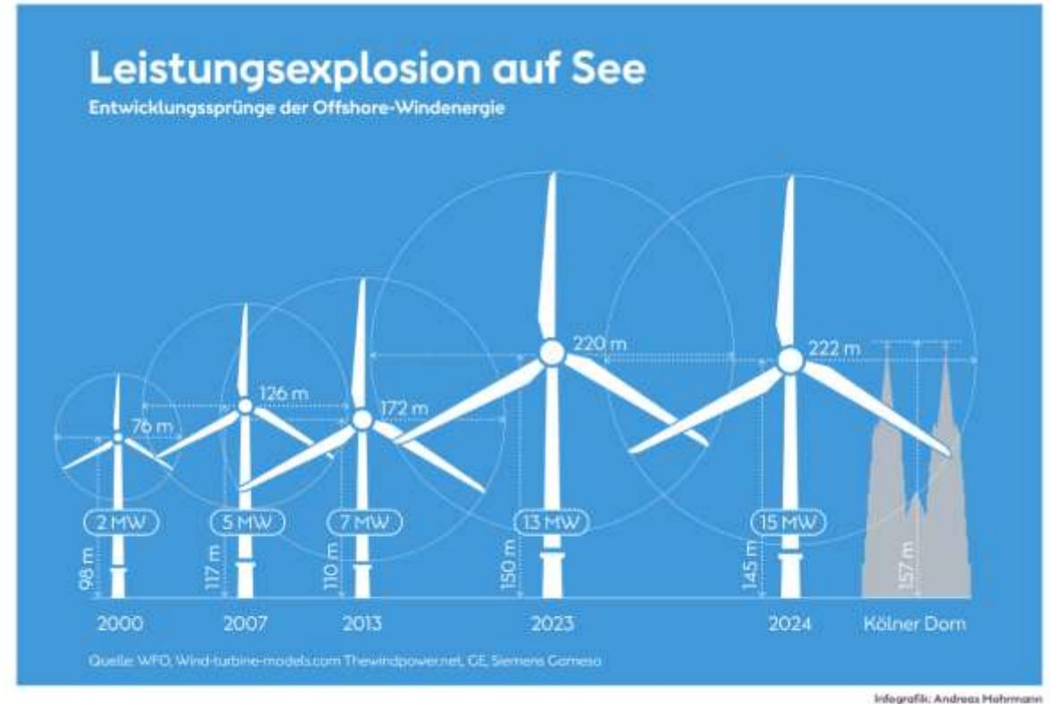
Auf dem Meer erzeugen Windräder Strom im zweistelligen Megawattbereich. Anlagen aus Holz sind für den Einsatz an Land bestimmt – und werden kleiner sein.
